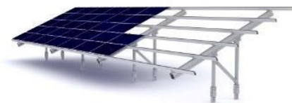
Figure 4 : Montage d'une table de plusieurs modules PV
